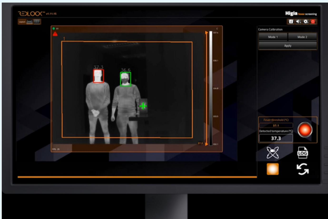
Una spin-off del Laboratorio de Sensores, Teledetección e Imagen en el Infrarrojo de la Universidad Carlos III de Madrid (UC3M), SENSIA Solutions, ha adaptado su tecnología de cámara termográfica, denominada HIGIA, para fabricar un nuevo sistema de alta precisión para la medición temperatura corporal a distancia, que puede utilizarse para detectar fiebre de las personas que acceden a instalaciones, ante la emergencia sanitaria provocada por la COVID-19
