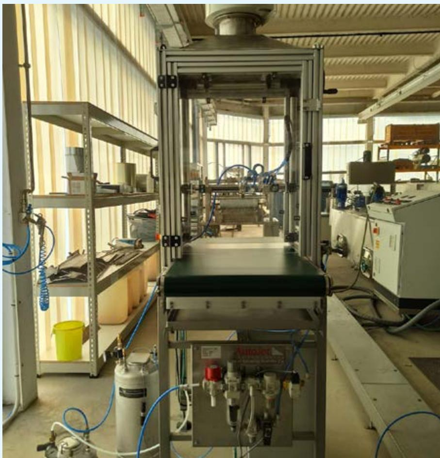
Estación automatizada para recubrimiento por spray en línea
