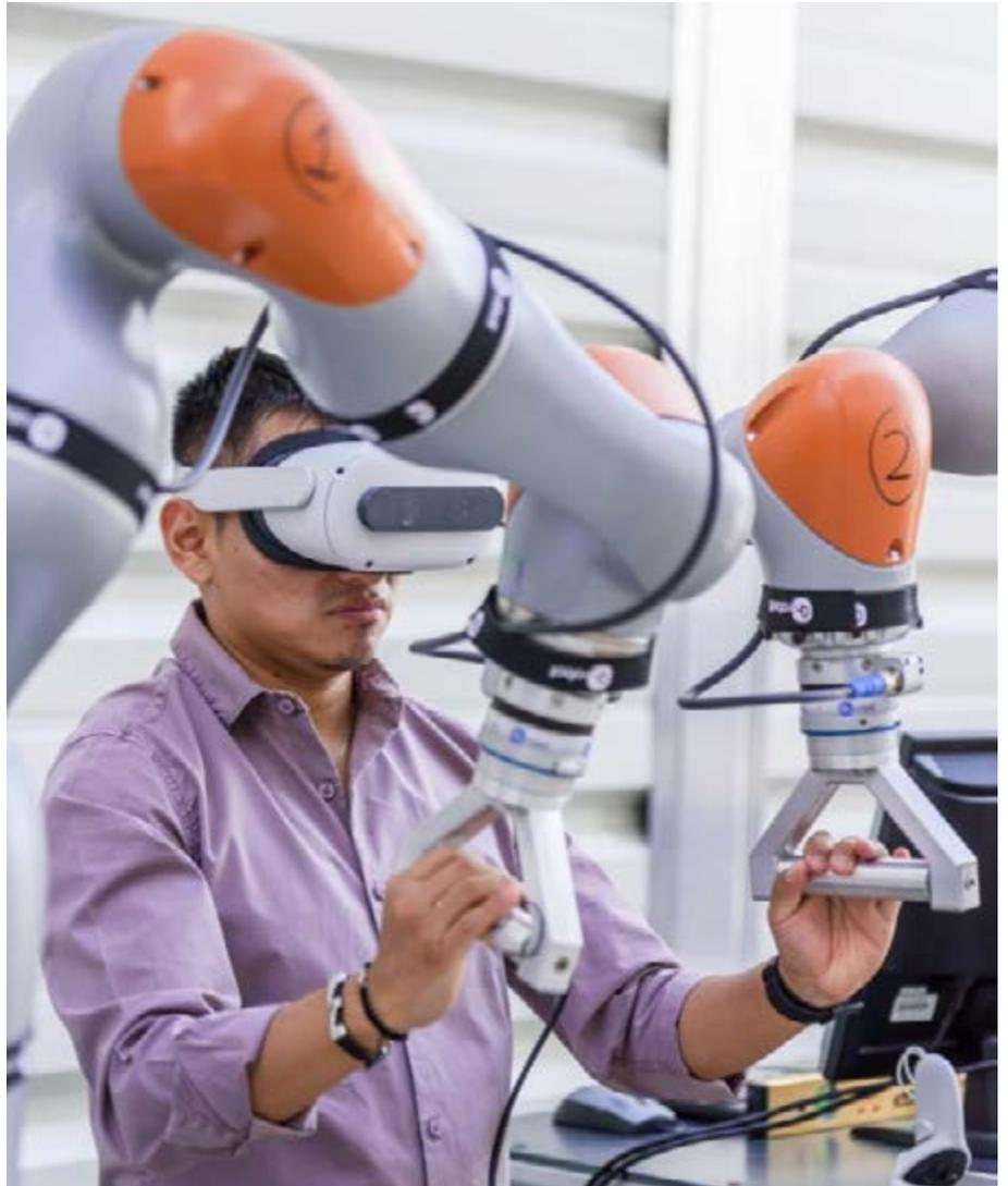
**Demostración del robot colaborativo IWA para lesiones neuromusculares (espasticidad) del RoboticsLab UC3M**
