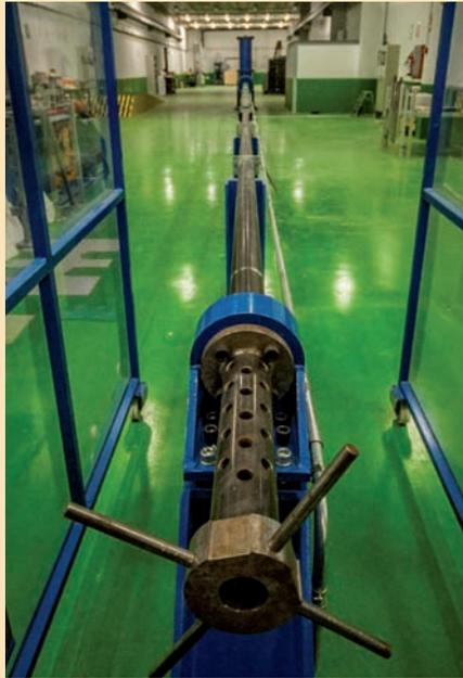
El laboratorio dispone de tres lanzadores con diferentes calibres que pueden alcanzar diferentes velocidades de impacto.
