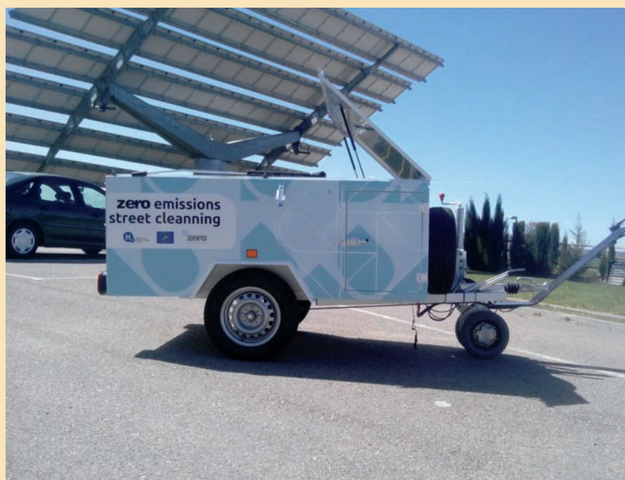
Hidrolimpiadora impulsada por una pila de combustible de hidrógeno.
