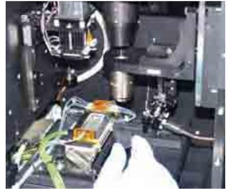
Vista del interior de un equipo GALx donde se observa la disposición de una flowcell, un Peltier y el microscopio que capta la incorporación de nucleótidos.
