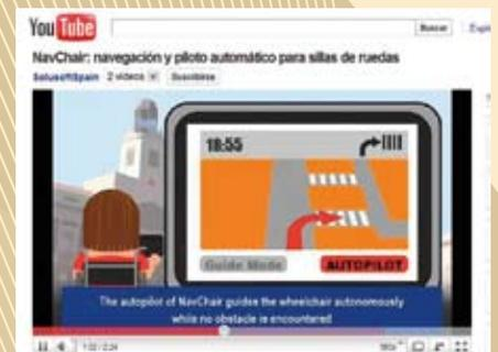
Dadas las especiales características de precisión del sistema Galileo frente al GPS tradicional, el objetivo último es un sistema de guiado automático de la silla que mejorará enormemente la ergonomía en su uso. El piloto automático guiará la silla dentro de la ruta calculada, aunque el ocupante podrá poner el modo manual en cualquier momento para ejercer todo su control sobre la misma.
