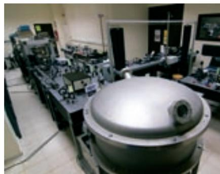
Instalaciones provisionales del CLPU en el sótano del edificio de Físicas de la Universidad de Salamanca. Al frente está el compresor de pulsos en vacío, al fondo a la derecha la sala limpia donde se encuentran los láseres y al fondo a la izquierda un sistema de generación de rayos X blandos (foto: Javier R. Vázquez de Aldana).
